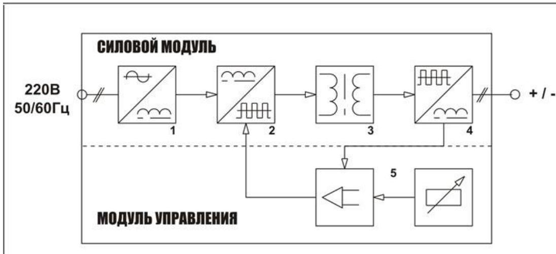
1. *Вход однофазного напряжения* питания, выпрямитель и конденсаторы. В аппарате применяются мощные электролитические конденсаторы известного производителя, фирмы «**JAMICON**», диодные мосты **GSIB2580 (IR)** – 2 шт.
