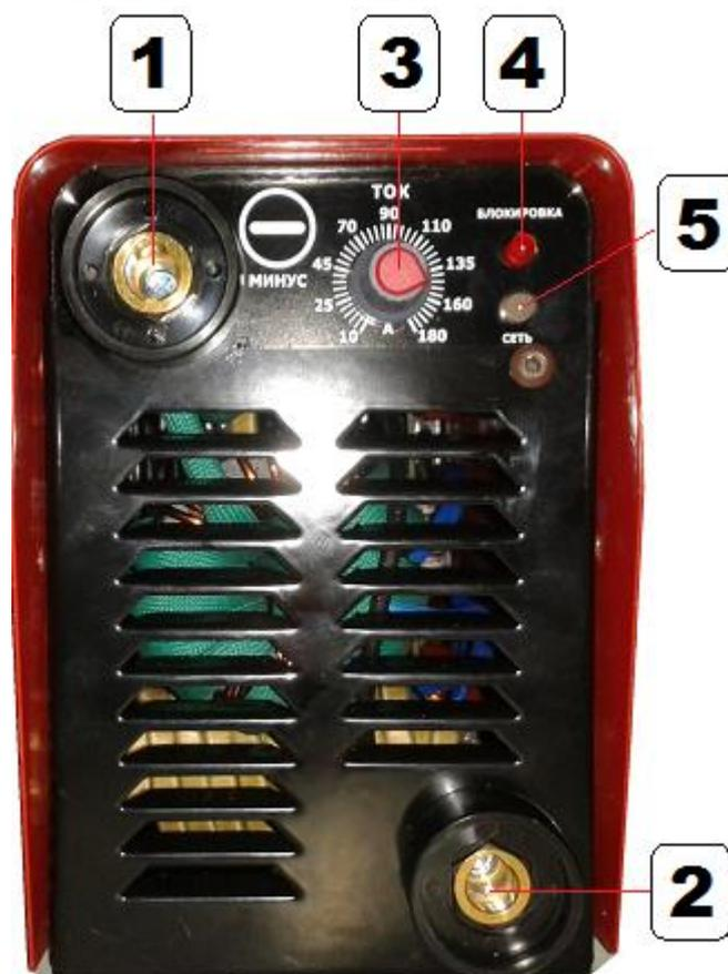
**1** – разъем «-» для подключения силового кабеля. При прямой полярности на «-» подключается электрододержатель.
